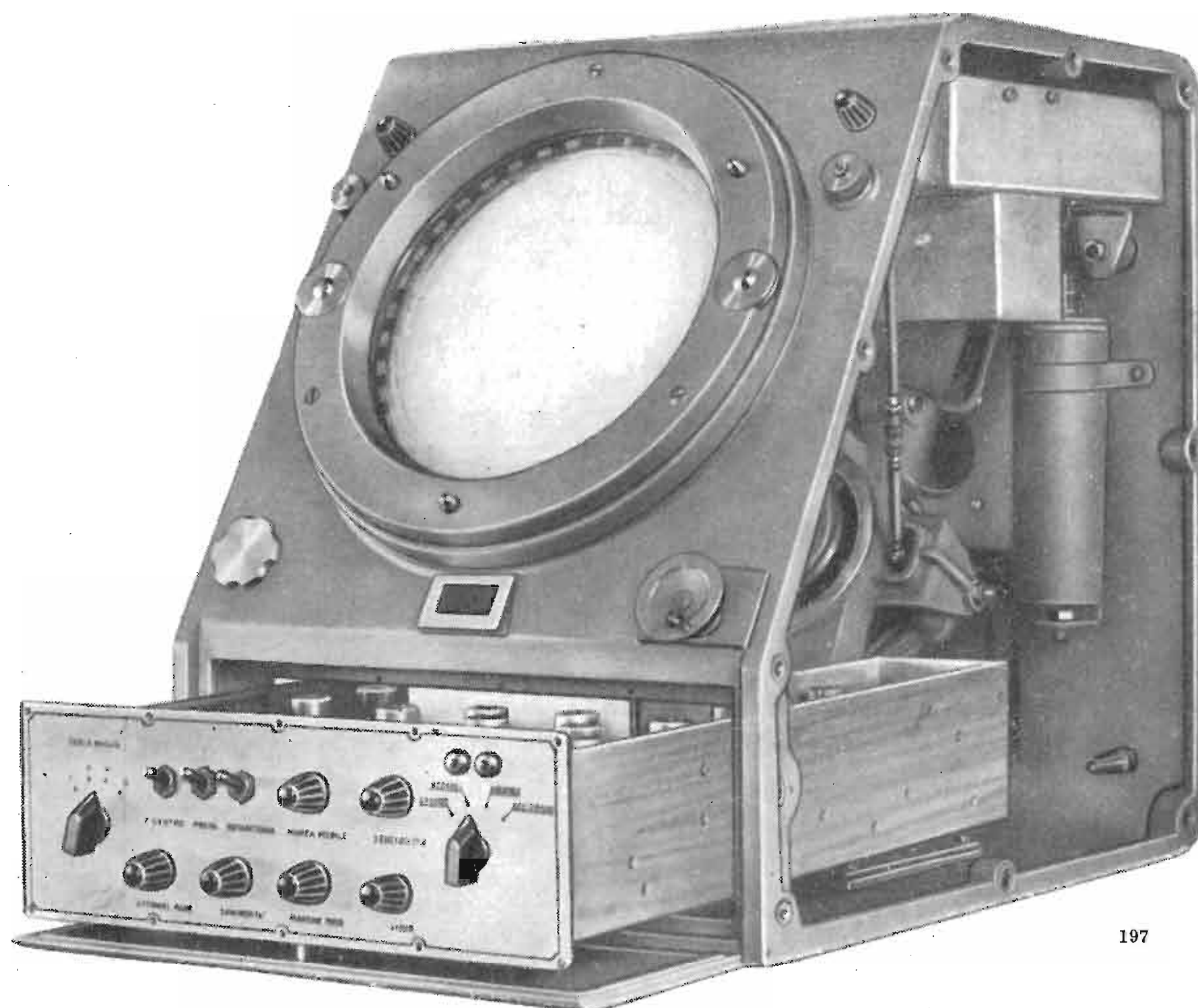
Indicatore principale con fiancata rimossa e pannello frontale parzialmente sfilato.
